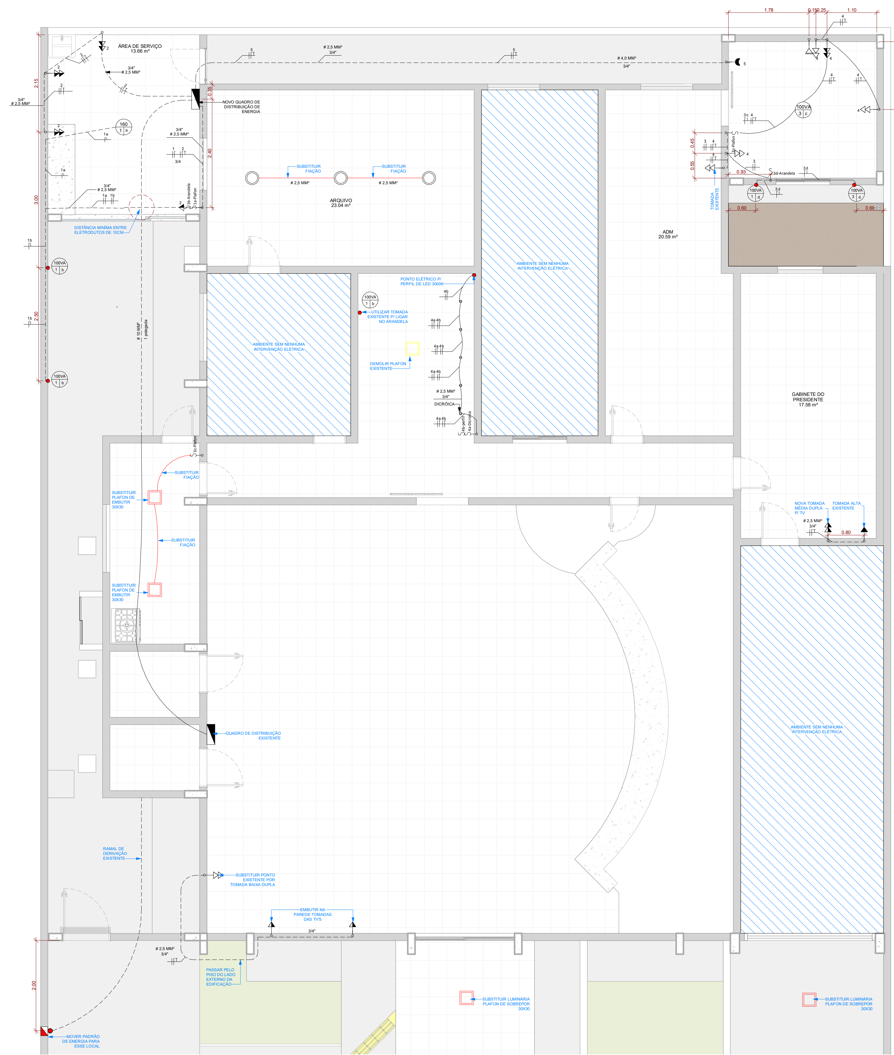
01 PLANTA ELÉTRICA ESCALA 1:50
